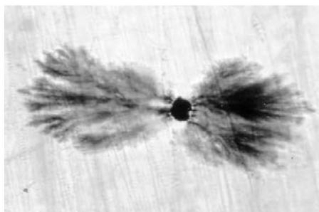
Многочисленные неполадки пластиковой оплетки после проведения испытаний напряжением постоянного тока подтверждают данные выводы. В связи с этим несколько лет назад была внедрена новая технология тестирования пластиковой оплетки.
