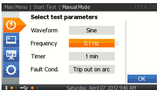
Установите частоту испытательного высокого напряжения как можно ближе к 0.1Гц.
