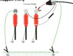
Измерительная схема с компенсацией коронных разрядов и поверхностных токов утечки
