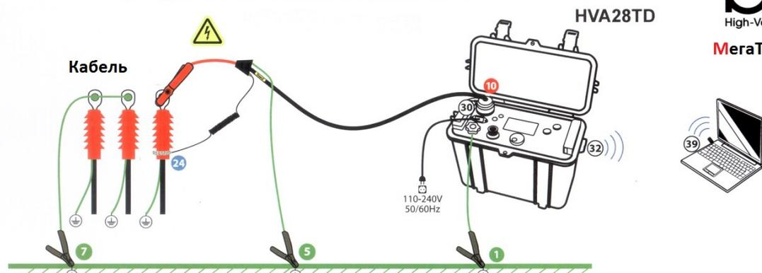
Обозначения и схема подключения : 1) Подключите все кабели заземления (зеленого цвета), 2) Подключите высоковольтный кабель (красный), 3) Подключите кабель питания установки и модуль передачи данных Bluetooth
