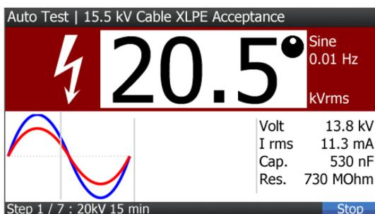
Испытание начнется автоматически. Установка отображает полное заданное время испытания и время, прошедшее, с начала испытания.
