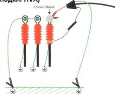
Измерительная схема с компенсацией коронных разрядов
