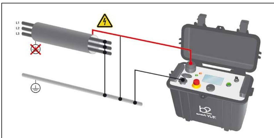
**HVA28** Измерительная схема для испытания оболочки кабеля и поиска места повреждения
