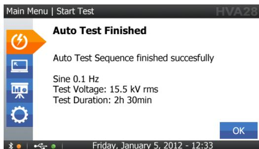
Экран отображает результат испытания изоляции в ручном режиме, вместе с условиями испытания.
