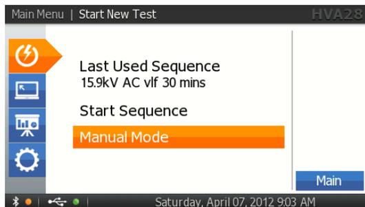
Выбрать ручной режим испытания “Manual Mode”
