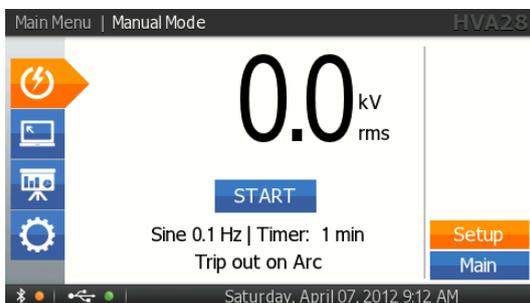
Для установки условий проведения испытания (вид выходного напряжения, его уровень, частота, продолжительность испытания, выберите меню установок “SETUP” в правом нижнем углу экрана
